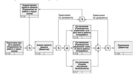
Рис. 2.5 – Использование нотации IDEF3 при формализации документооборота.
